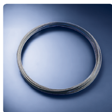
36.7003.20 Edelstahlseil 3 mm 7 x 7, WST 1.4401 Zugfestigkeit 5000 N Preis je angefangenem Laufmeter
